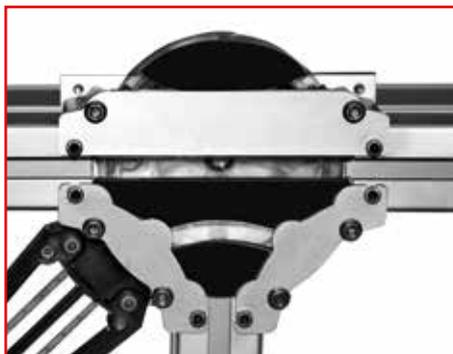
Aiguillage tournant à 3 voies
